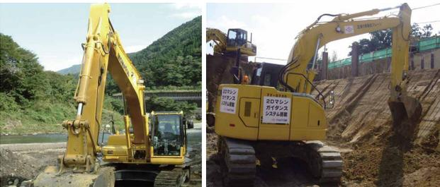
3次元の設計データを基にGNSS制御・自動TS制御による3Dマシンガイダンス、レーザーレベル・角度センサーによる2Dマシンガイダンスまで、オペレーターからは視認が困難な場所においても、掘削面・整形面とのリアルタイムな位置関係がモニター可能なため、現場に精度向上とオペレーターの負担が軽減できます。
