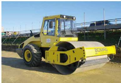
GNSSやトータルステーションを活用し、転圧機で締固めた回数や地盤反力、仕上がり高を面的に管理します。締固めの回数管理だけでなく、出来形や度量計算にも利用可能です。
