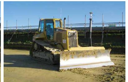
オペレーターにキャビン内に設置したモニター画面を通じて、リアルタイムに切土・盛土高を計算し、表示するとともに、敷均し後の出来形を自動計測しデータを保存します。
