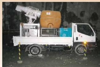
ダストセイバートラック搭載型トラックに細かい霧を発生させる装置を搭載し、湿潤養生を行う。
