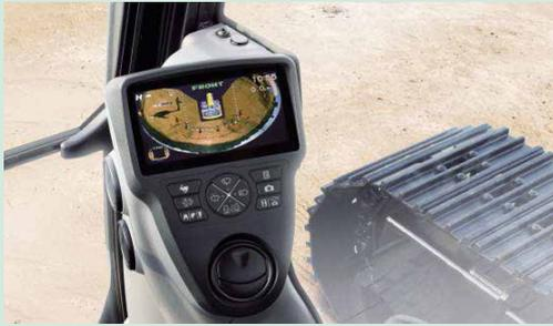
掘削機では後方部下が死角になります。死角の部分を補うため、超音波センサーや小型モニターで確認することができましたが、フィールドビューモニターは3台のカメラの映像を画像処理技術で合成し、270度のワイドな視界で後方を確認できます。NETIS登録番号:KT-110057-V
