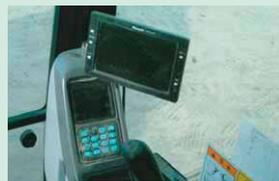
マグネットにより簡単に設置ができます。設置面積が多い筒型のため、頑丈に取り付けられます。また、CCDカメラからの信号をワイヤレスにて送受信が可能です！
