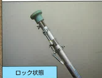
4.9棒 (5m高さ対応型用) の突張り方法
