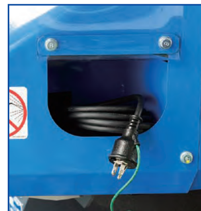
≫延長ケーブル収納部 02
